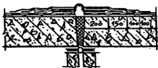
ДЕФОРМАЦИОННЫЙ ШОВ С ГИБКИМ КОМПЕНСАТОРОМ
