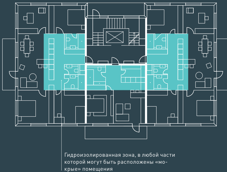
Илл. 52. Пример расположения гидроизолированной зоны
