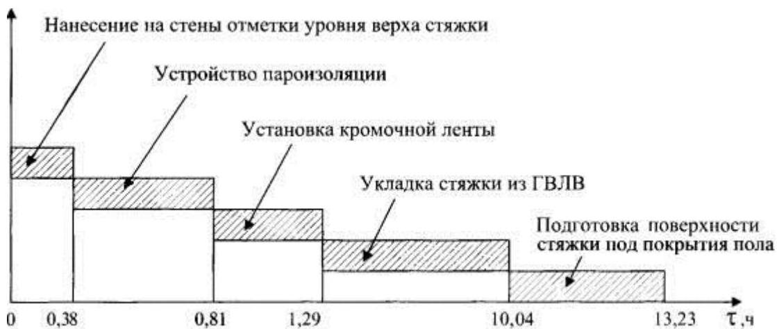
Рис. 6.3 а. График движения рабочей силы при устройстве сборного основания типа «Альфа» из малоформатных гипсоволокнистых листов влагостойких (к табл. 6.3.1)
