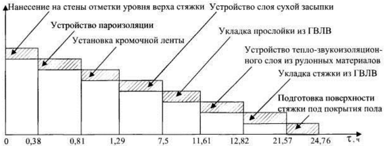
Рис. 6.10.2 а. График движения рабочей силы при устройстве сборного основания типа «Гамма» по выравнивающему тепло-звукоизоляционному слою сухой засыпки толщиной 100 мм с прослойкой из ГВЛВ на тепло-звукоизоляционном слое из рулонных материалов со стяжкой из ГВЛВ (к табл. 6.10.2)
