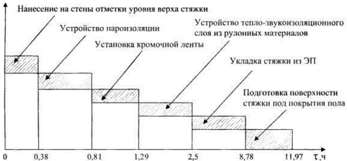
Рис. 6.3.2. График движения рабочей силы при устройстве сборного основания типа «Бета» на тепло-звукоизоляционном слое из плитных материалов со стяжкой из элементов пола (к табл. 6.3.2)
