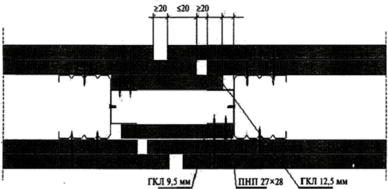
Рисунок 12 — Схема монтажа элементов каркаса перегородки С 112
