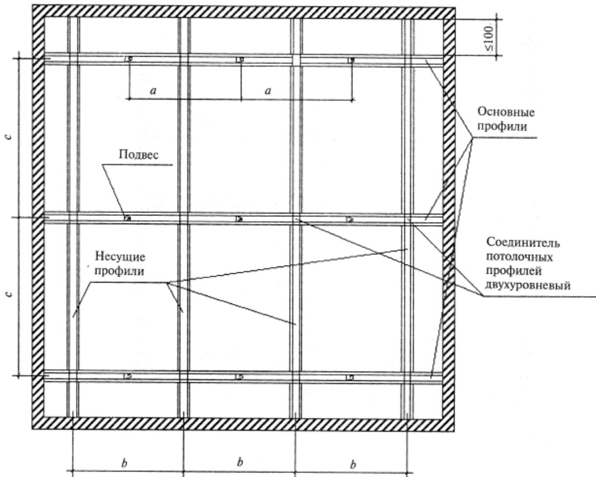
Межосевые расстояния при устройстве каркаса
