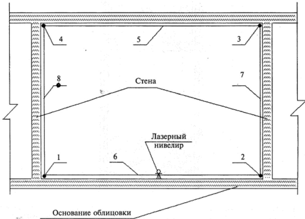
1, 2, 3, 4 - нанесение точек на основные конструкции помещения; 5, 6, 7, 8 - разметка оси шнуруотбойным устройством
