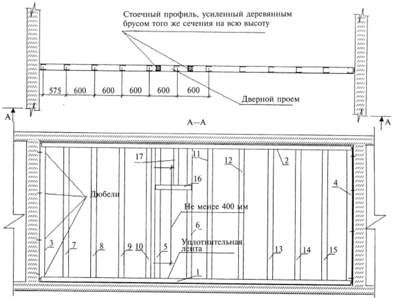
1, 2, 16 - направляющий профиль (ПН); 3-15, 17 - стоечный профиль (ПС)
