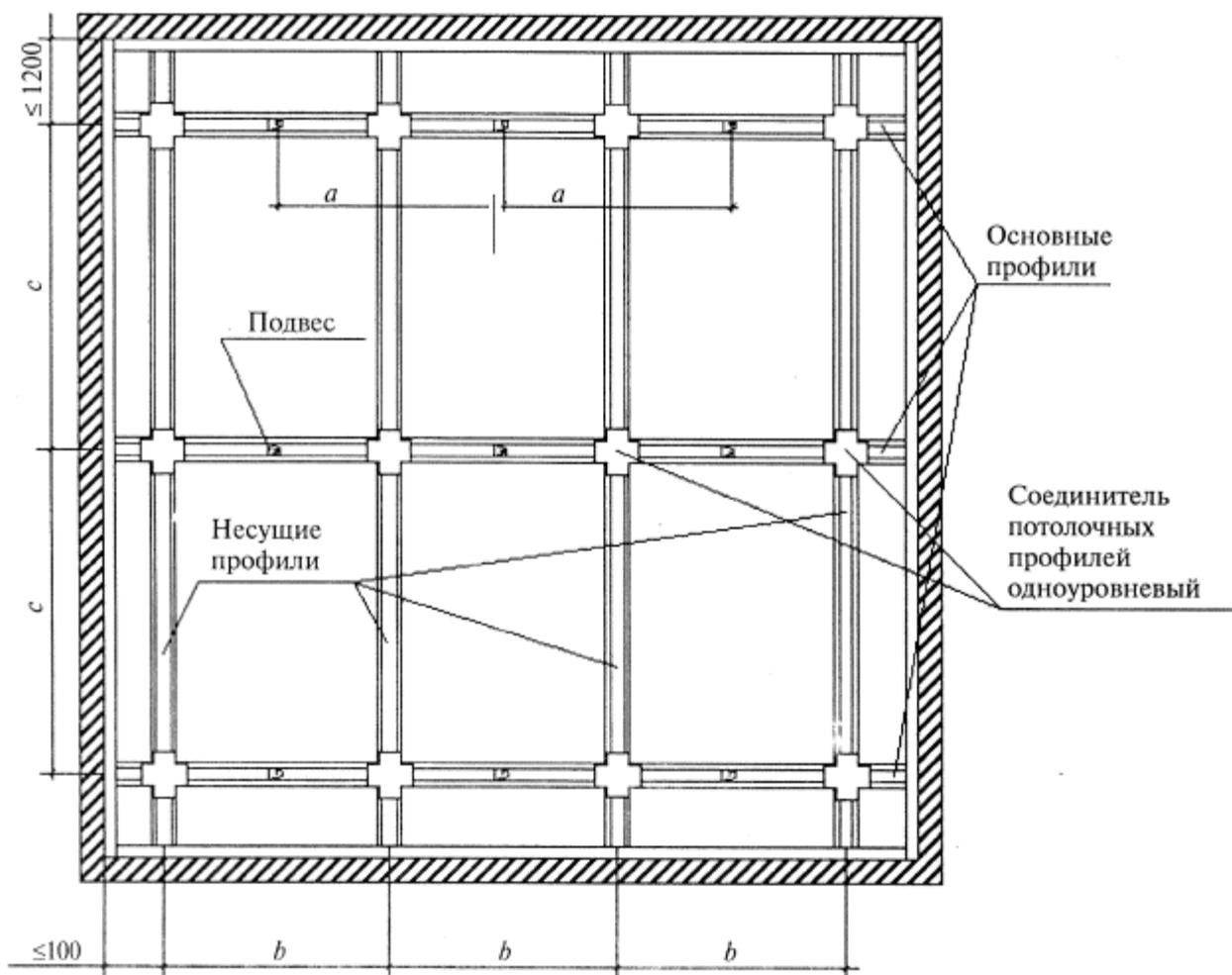
Межосевые расстояния при устройстве каркаса
