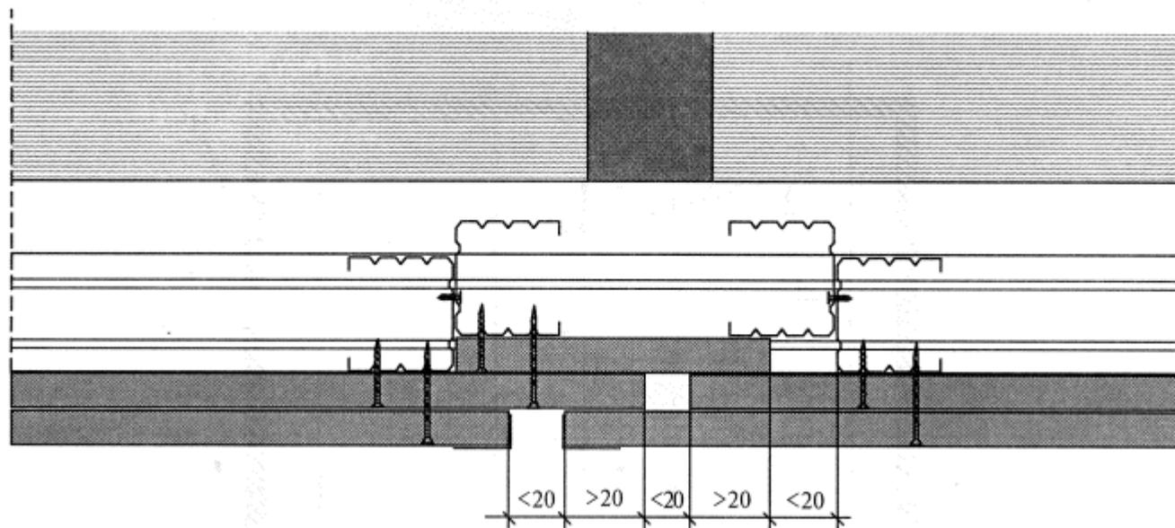
Примечание - При устройстве деформационных швов требуется установить дополнительно два стоечных профиля по обеим сторонам шва.
