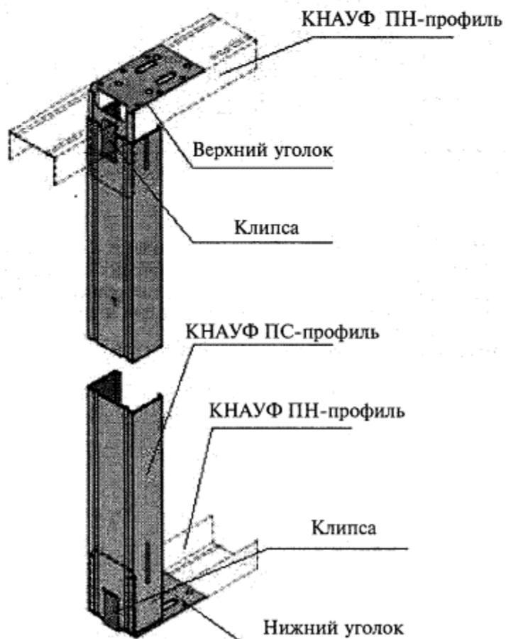
Рисунок 7 - Монтаж элементов дверного проема
