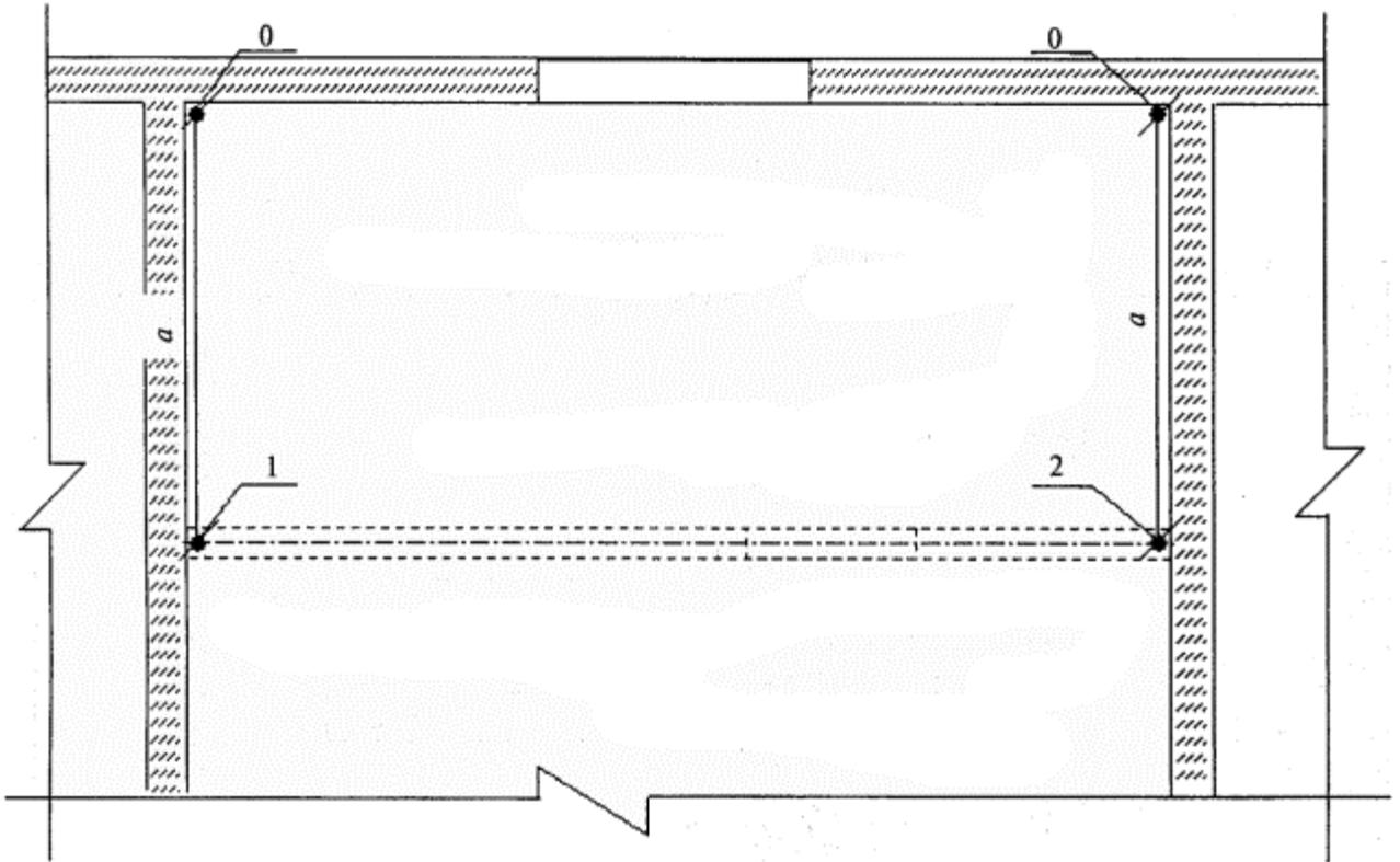
1, 2 - ось каркаса перегородки, параллельная основной конструкции здания; а - расстояние между стеной и осью перегородки (план)
