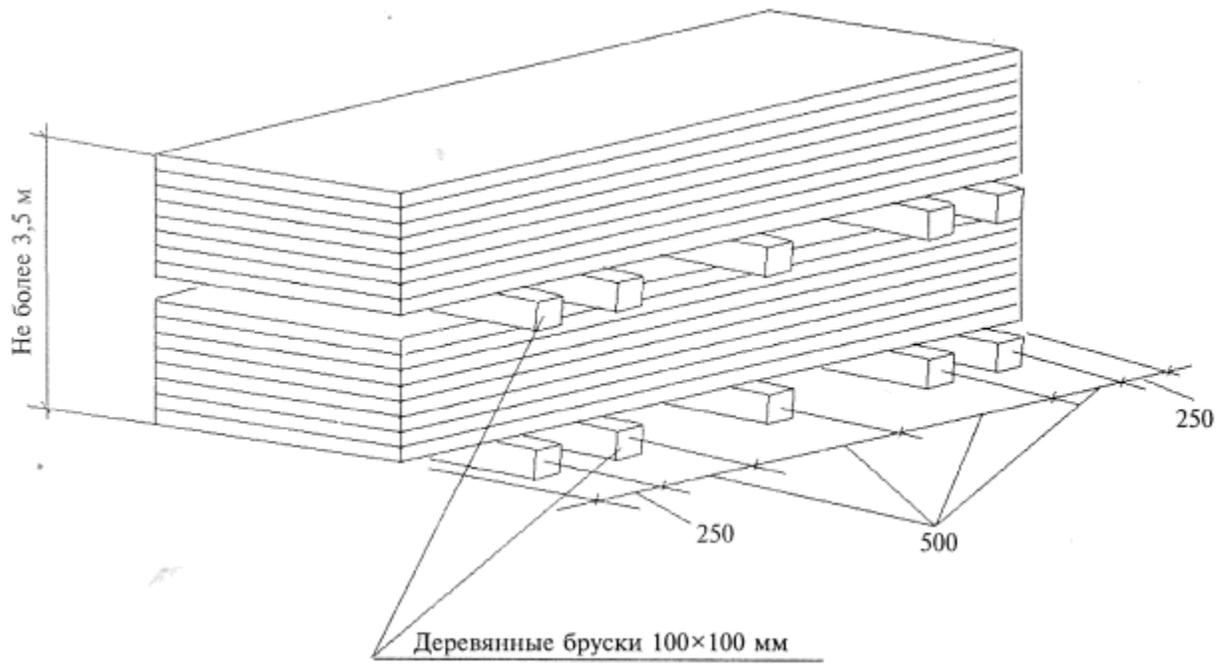
Рисунки 2 - Схема складирования ГВЛ на объекте
