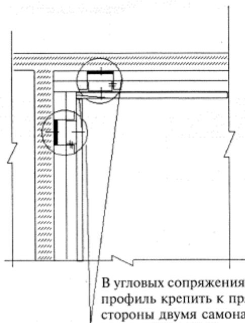
Рисунок 23 - Схема крепления стоек каркаса с помощью прямых подвесов в облицовке С 663
