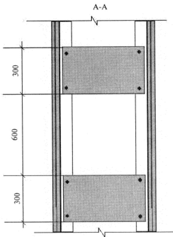
1 - направляющие профили пола; 2 - стоечные профили, примыкающие к основным конструкциям; 3 - стоечные профили; 4 - вставка из ГВЛ; 5 - первый слой ГВЛ; 6 - второй слой ГВЛ
