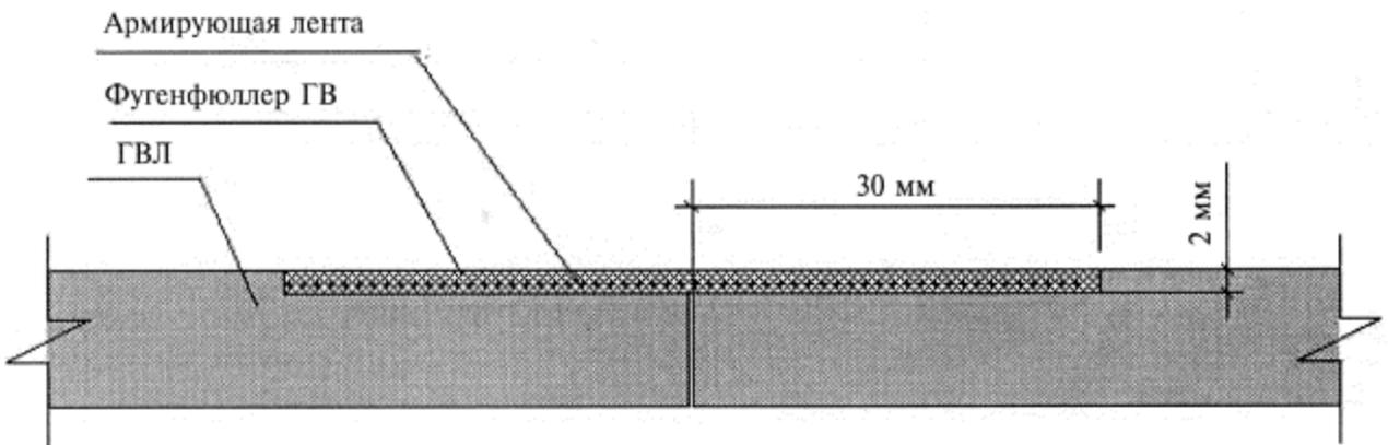
Рисунок 5 - Схема устройства горизонтального шва
