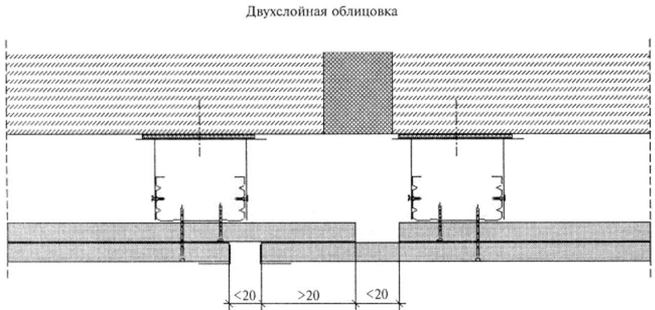
Примечание - При устройстве деформационных швов требуется установить дополнительно два потолочных профиля по обеим сторонам шва.
