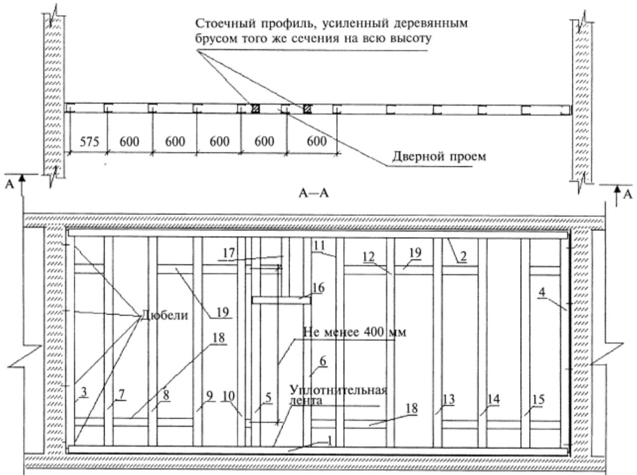
1 - ПН на полу; 2 - ПН на потолке; 3, 4 - ПС, примыкающие к конструкциям здания; 5, 6 - ПС, ограничивающие дверной проем; 7-75- монтаж профиля каркаса с сохранением проектного шага; 16 - монтаж перемычки над дверным проемом; 17- монтаж ПС с сохранением шага над дверным проемом; 18, 19 - монтаж горизонтальных вставок из ПН под горизонтальные швы ГКЛ
