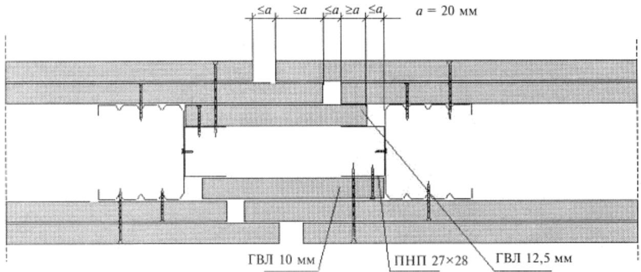
Рисунок 11 - Схема устройства деформационного шва в перегородке С 362
