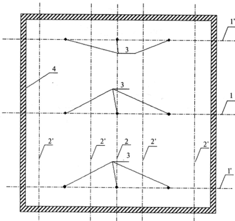
1, 2 - разметка центральных взаимно перпендикулярных осей; Г - разметка положения основных профилей; 2 - разметка положения несущих профилей; 3 - разметка положения подвесов потолка; 4 - разметка на примыкающих стенах помещения положения профилей ПНП (для конструкции П 213)
