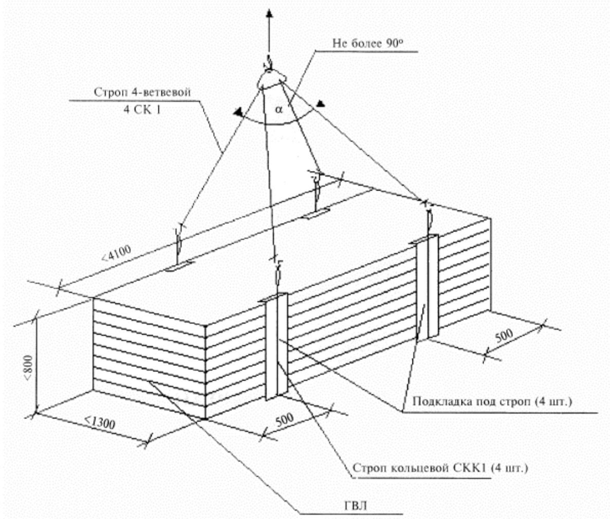
Рисунки 1 - Схема строповки пакета ГВЛ
