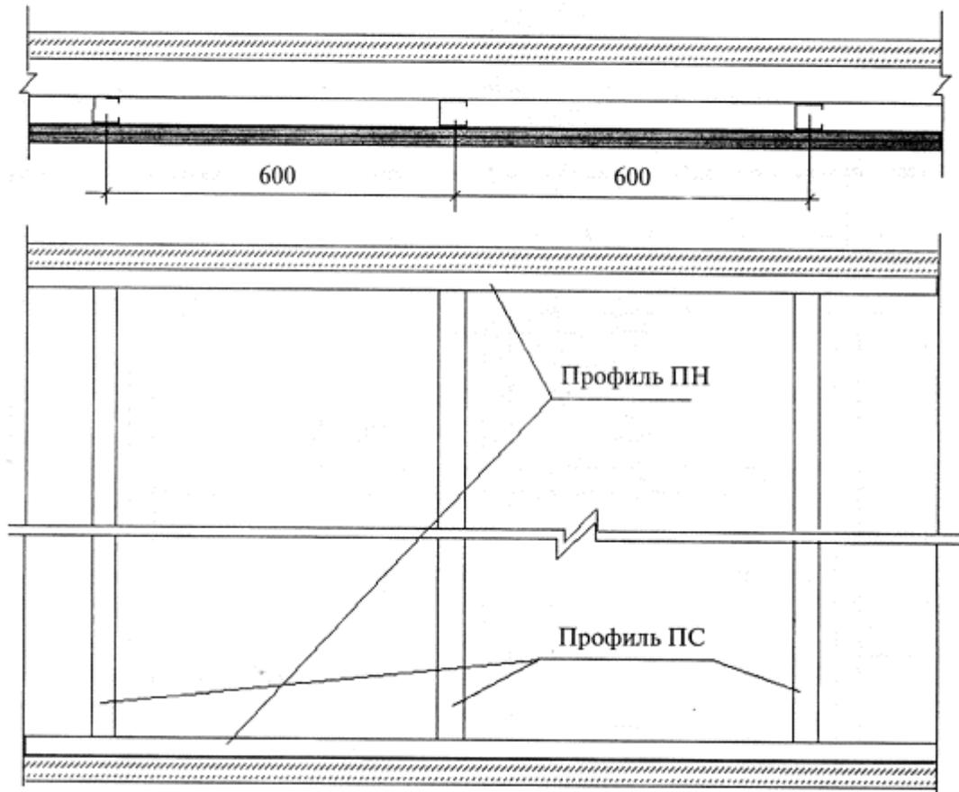
Рисунок 26 - Схема монтажа каркаса в облицовке С 666
